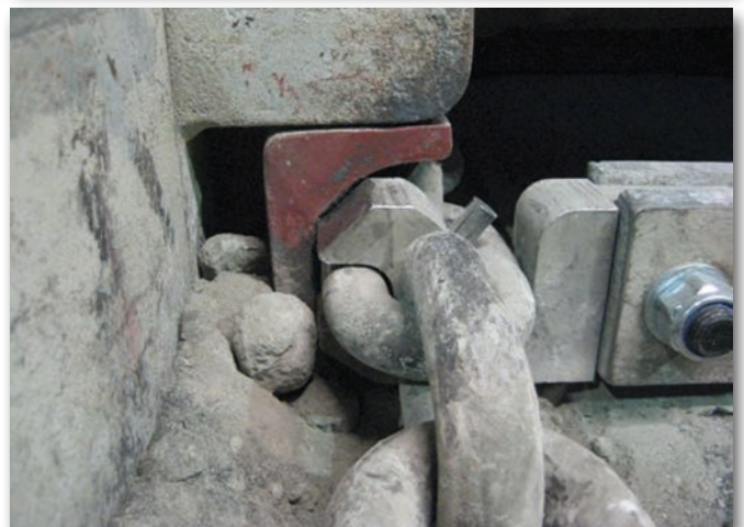
Uniwersalne uchwyty umożliwiają wykorzystanie posiadanych zgrzebł i zastosowanie łańcuchów w długich odcinkach
